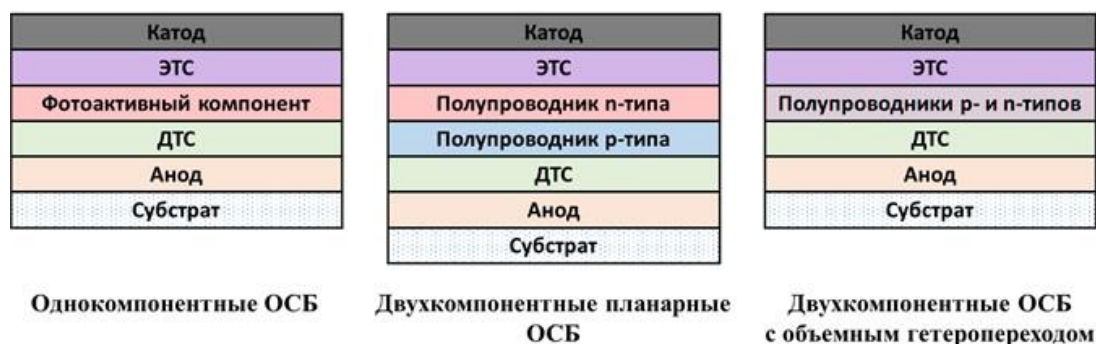
Рисунок 1.3 – Схематическое изображение архитектуры различных типов ОСБ, где ДТС – дырочно-транспортный слой, ЭТС – электрон-транспортный слой
