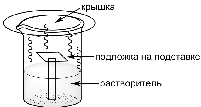
Рис. 85. Схема эксперимента по отжигу активного слоя фотоэлемента в парах растворителя
