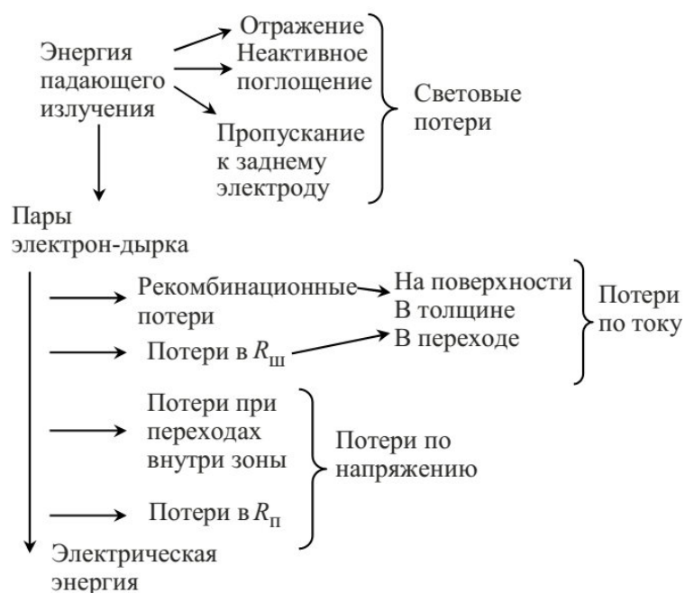
Рис. 5. Виды потерь мощности при работе фотоэлемента [28].
