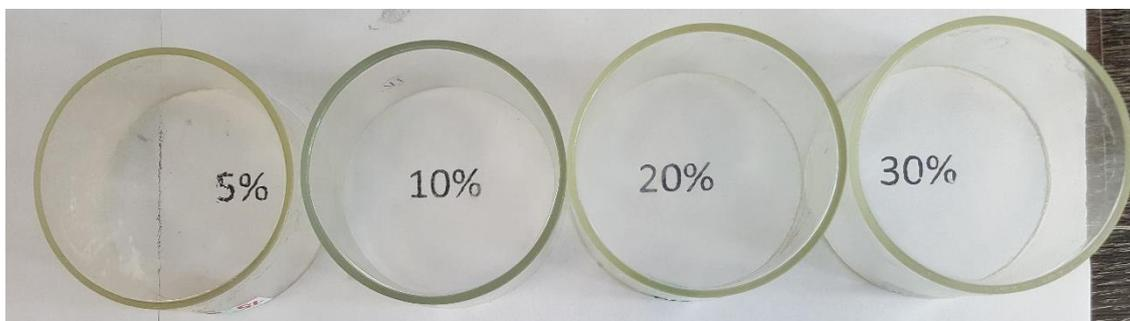
**Рисунок 86:** Фотография полученных пленок, содержащих 5, 10, 20 и 30% отверждающего агента соответственно.
