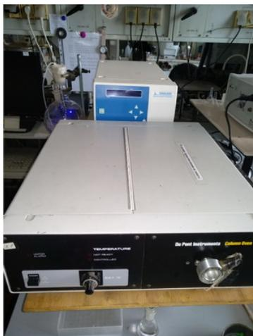
Состоит из: насос высокого давления СТАЙЕР с.2 (Аквилон, Россия), детектор рефрактометр Smartline RI 2300 (KNAUER, Германия) и термостат Du Pont (Du Pont Instruments, США). Температура  $40 \pm 0,1^\circ\text{C}$ , элюент – Тoluол, скорость потока – 1,0 мл/мин. Обработка хроматограмм и расчет молекулярно-массовых параметров программа МультиХром для Windows версия 1.6. (Амперсенд, Россия)
