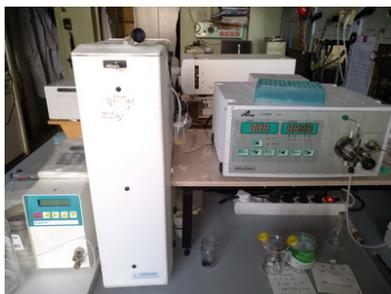
Состоит из: насос высокого давления СТАЙЕР с.2 (Аквилон, Россия), детектор рефрактометр Smartline RI 2300 (KNAUER, Германия) и термостат JETSTREAM 2 PLUS (KNAUER, Германия). Температура  $40 \pm 0,1^\circ\text{C}$ , элюент – ТГФ, скорость потока – 1,0 мл/мин. Обработка хроматограмм и расчет концентраций программа UniChrom для Windows версия 4.7 (Новые аналитические системы, Беларусь)
